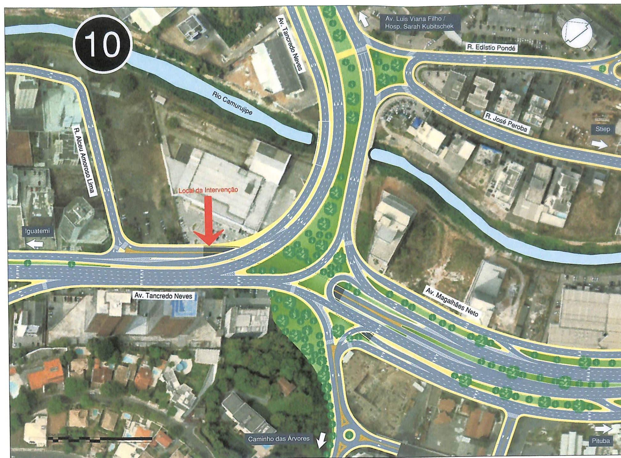
10 - TRINCHEIRA : sob Av. Tancredo Neves na ligação com Av. Magalhães Neto
