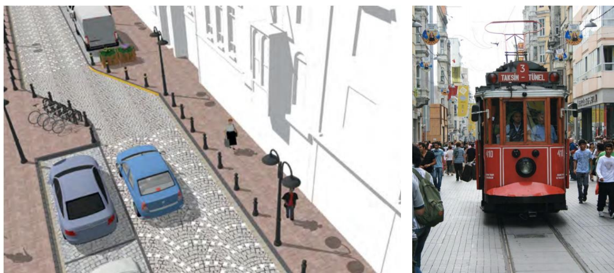
FIGURA 5.4.1.B - EXEMPLO DE MEDIDAS DE MODERAÇÃO DE TRÁFEGO – CHICANA E COEXISTÊNCIA SEGURA ENTRE PEDESTRES E BONDE ELÉTRICO EM ISTAMBUL, TURQUIA 59
