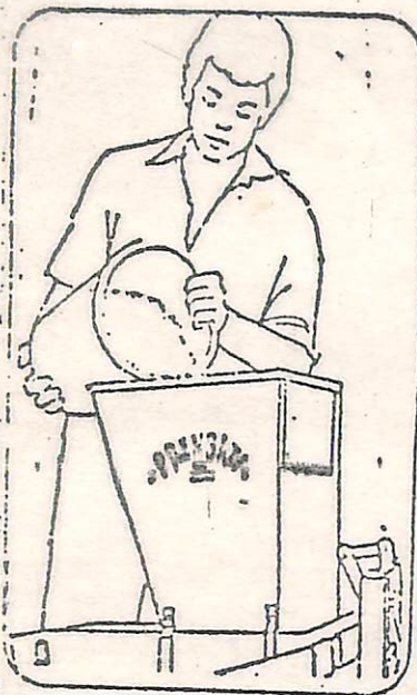
Nº 1 COLOCANDO A TERRA JÁ PREPARADA.
