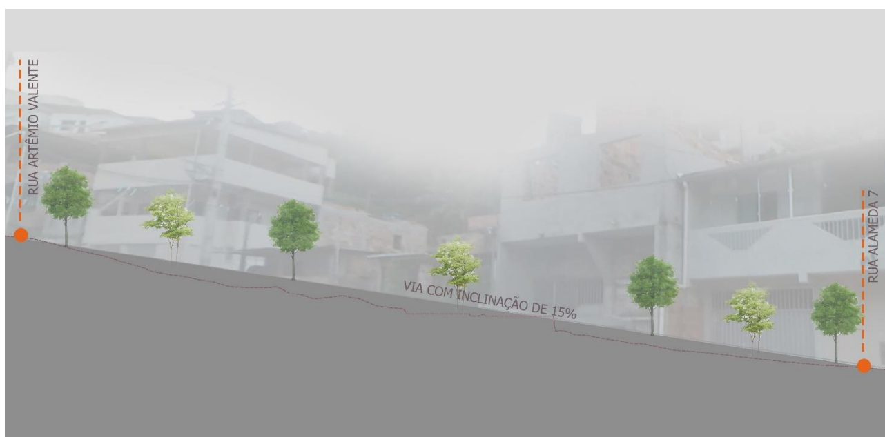
Figura 27 - Perfil longitudinal da Alameda 7
