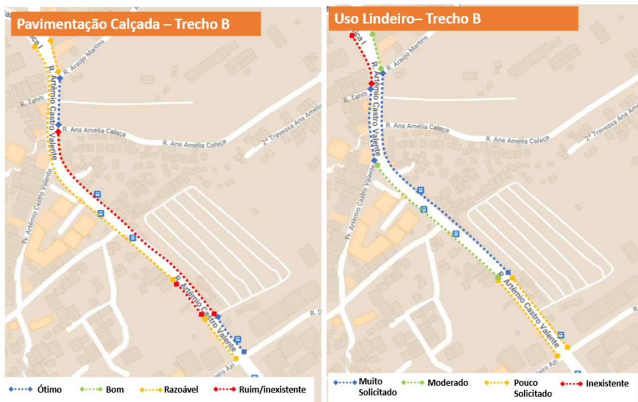
Figura 116 - Análise da pavimentação das calçadas e do uso lindeiro no Trecho B Fonte: Elaboração própria
