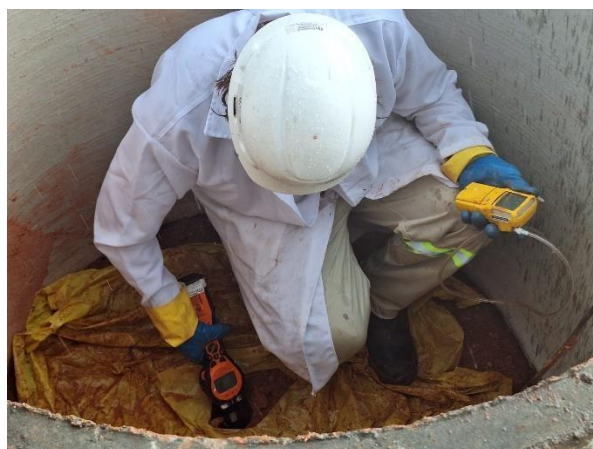
Foto 3.15: Utilização do Medidor de VOC em campo
