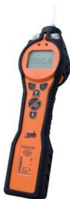
Foto 3.14: Equipamento Procheck Tiger – detector de VOC.
