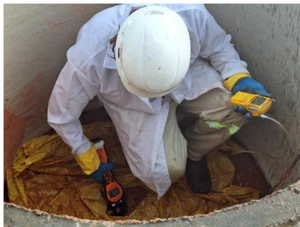
Foto 3.15: Utilização do Medidor de VOC em campo
