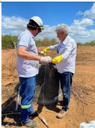
Foto 2: Verificação do nível estático do poço
