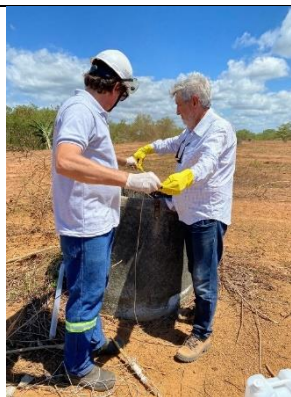
Foto 2: Verificação do nível estático do poço
