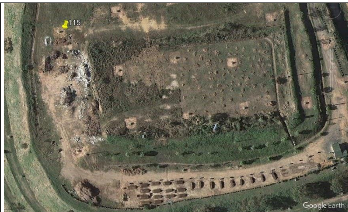
Figura 25 – Indícios de disposição de lixo hospitalar na porção sul da Fase A. Observa-se material não recoberto na porção oeste da imagem. Algumas feições parecidas com leiras, são visíveis na porção extrema sul da imagem, não se tendo informações sobre que tipo de material está formando estas leiras.
