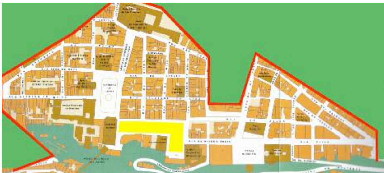
Figura 2 – Trecho da planta atual do Centro Histórico de Salvador 4 (levantamento aerofotogramétrico), correspondente ao mesmo trecho representado por Albernaz, onde pode ser percebida a manutenção, praticamente integral, do traçado seiscentista. A área em amarelo foi das mais modificadas, especialmente na década de 30 do século XX, quando foram demolidos dois quarteirões assim como a antiga igreja da Sé.
