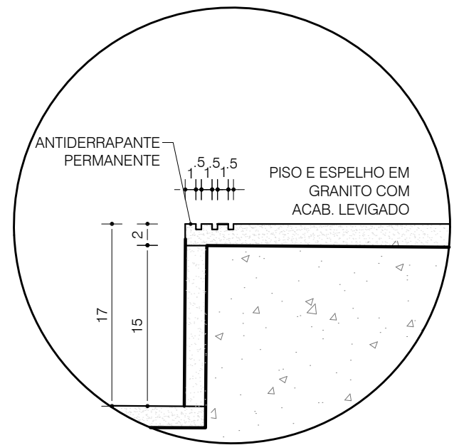
DETALHE 04 PISO - DETALHE RANHURAS NO GRANITO ESC.: 1/5
