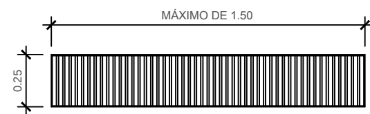
VISTA SUPERIOR GRELHA DE AÇO INOXIDÁVEL ESCALA 1/20
