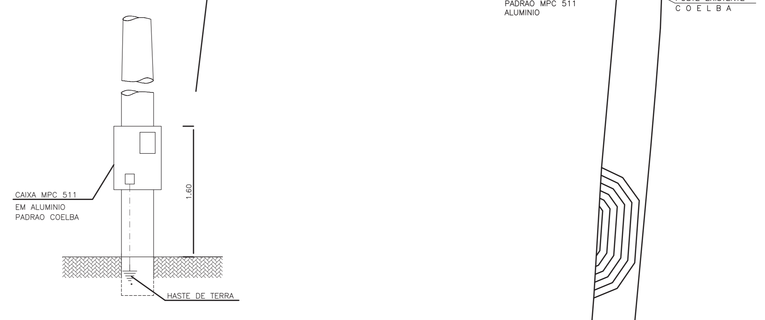
DETALHE POSTE EXISTENTE
