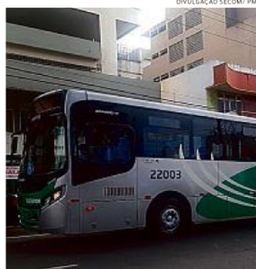
O ônibus em teste é da marca Volvo, equipado com ar-condicionado, tem portas em ambos os lados e 15 metros de comprimento
